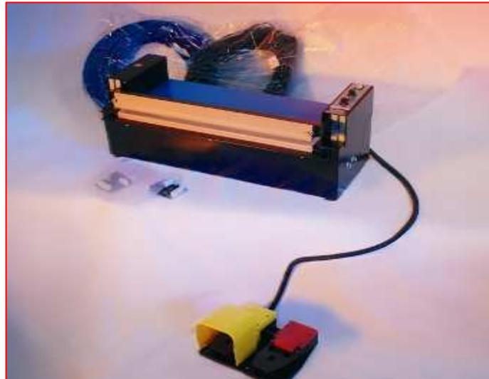
Questa saldatrice esegue un particolare tipo di saldatura "a micronastro" analoga alla saldatura a filo per l'aspetto e la rapidità di esecuzione, e che separa con un taglio a caldo i lembi del film.
