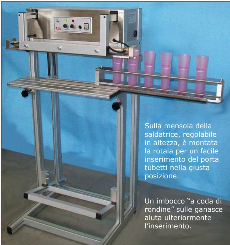
Sulla mensola della saldatrice, regolabile in altezza, è montata la rotaia per un facile inserimento del porta tubetti nella giusta posizione.
